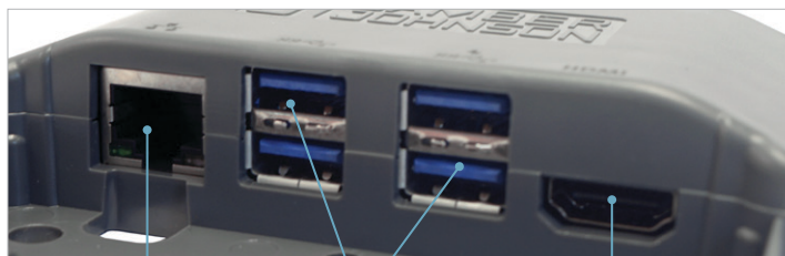
(1) ETHERNET RJ45 (GIGABIT)
